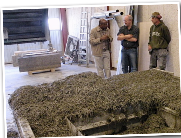
David Ndungu studerar väggblockstillverkning av cementbundet träull på Träullit i Österbymo.
